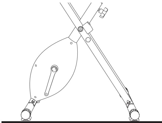
13. ペダルを取り付けます。まず図のようにペダルに刻印されているR・Lを確認してください。
