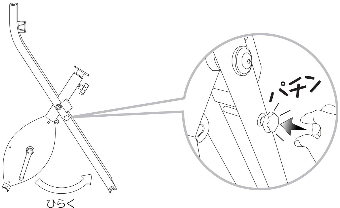
3. 後ろフレームにあらかじめ仮止めされているナットとワッシャを外し、本体の後ろ足を差し込み、外したナットとワッシャで工具Aを使用して固定します。
